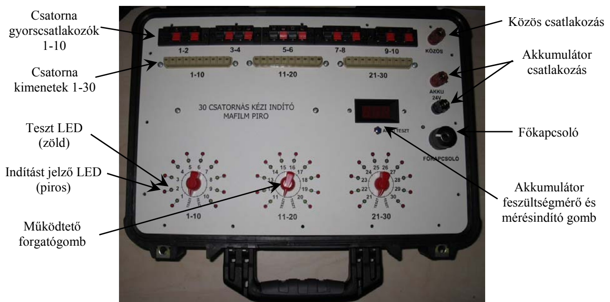
3. ábra – A forgatógombos indítógép részei
