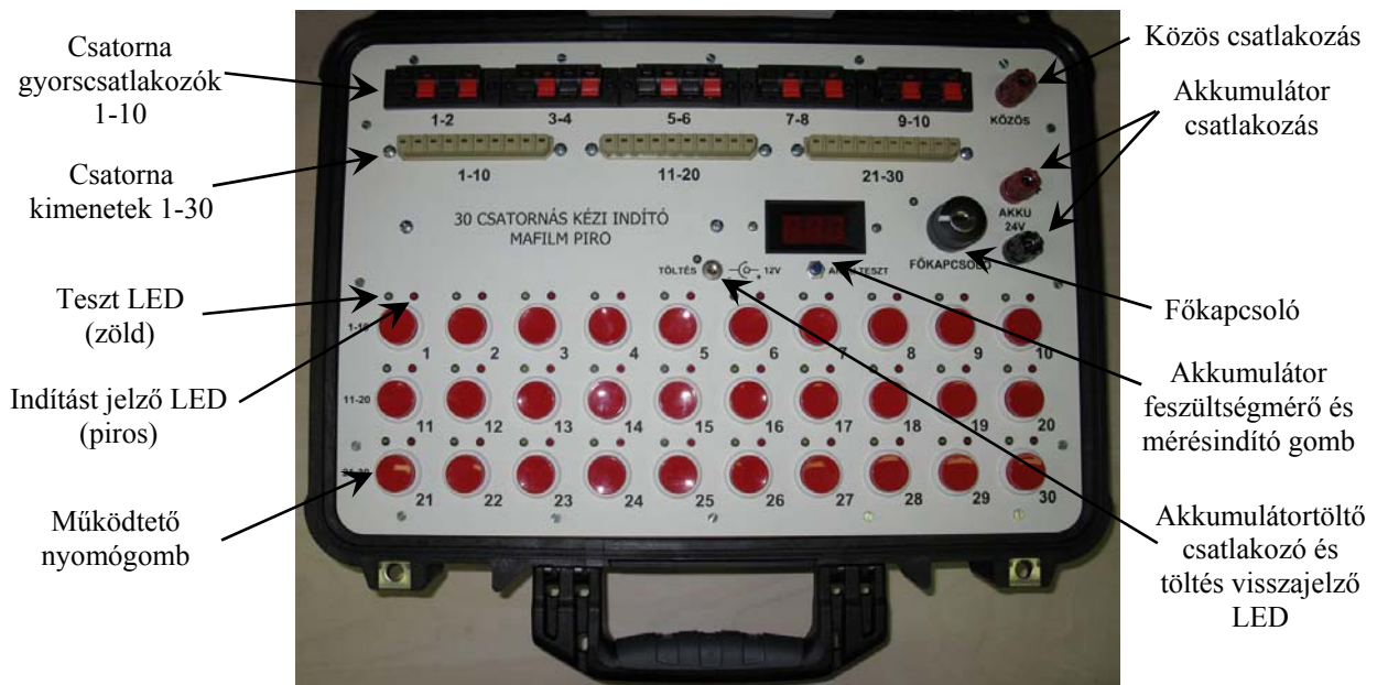
2. ábra – A nyomógombos indítógép részei
